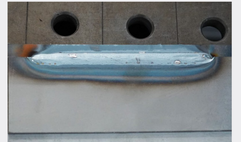
板材2mm，间隙3mm
